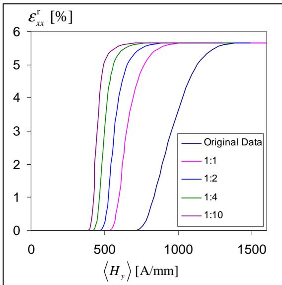
Figure 14. INFLUENCE OF SPECIMEN ASPECT RATIOS ON THE CORRECTION OF THE MFIS DATA.
