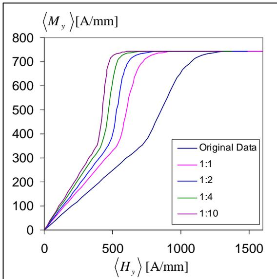
Figure 13. INFLUENCE OF SPECIMEN ASPECT RATIOS ON THE CORRECTION OF THE MAGNETIZATION DATA.
